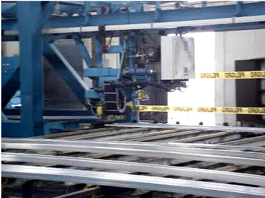
(1) 雙牽引機，左車頭牽引。 Double Puller, Left Puller Head pulling.
